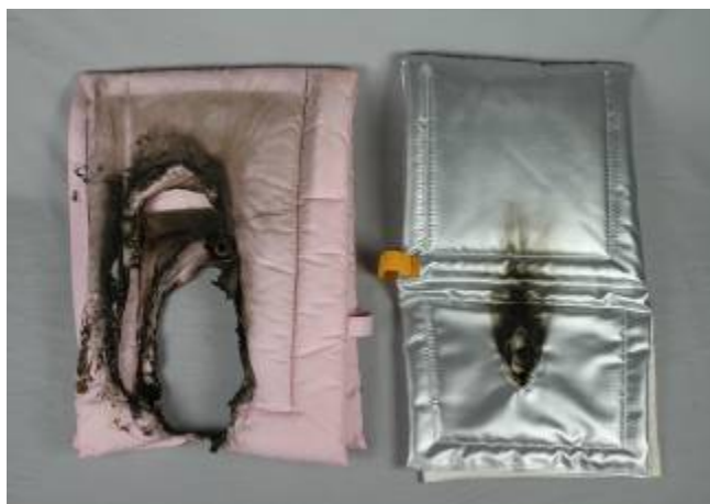
写真6. 防災性能確認後の検体の一例 (左：非認定品 右：認定品)
