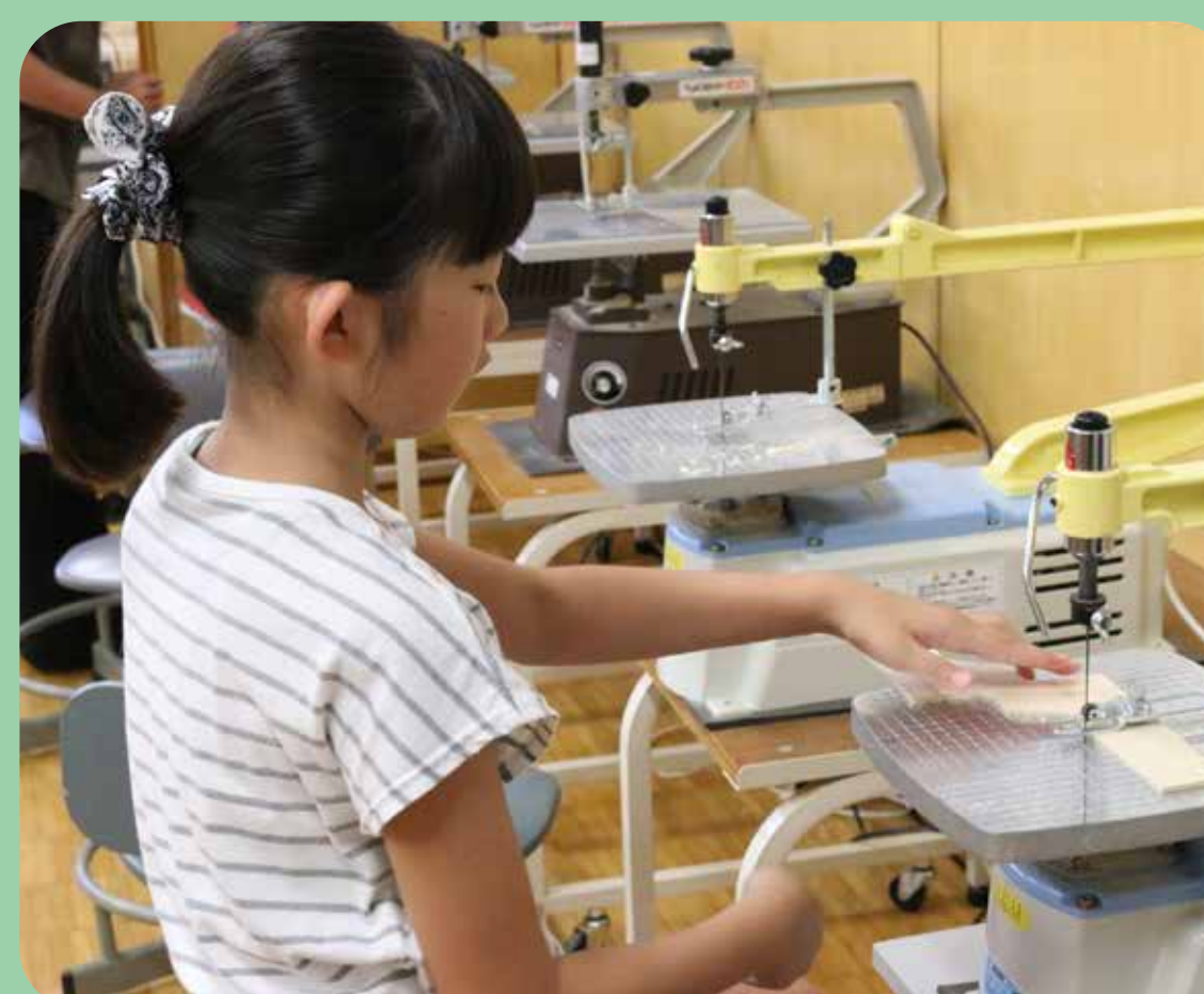
3. 電動糸のこで木をカットしています。ゆっくり急がずに。
